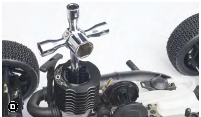
Schrauben Sie den Zündkerzenschlüssel im Uhrzeigersinn bis zum Anschlag
