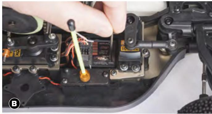
Poser le véhicule sur un bloc pour éviter que les roues ne touchent le sol. Allumer l'émetteur et l'indicateur de batterie s'allume. Si il clignote ou ne s'allume pas, vérifier les polarités et l'alimentation des piles. Si l'énergie des piles est faible, remplacer les piles par des neuves.
