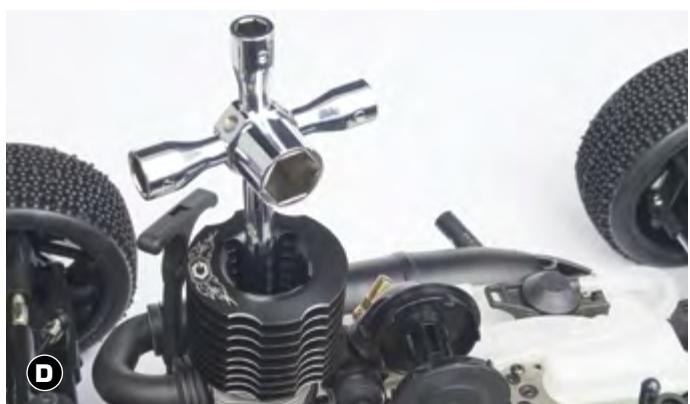
Visser la clé à bougie dans le sens des aiguilles d'une montre.
