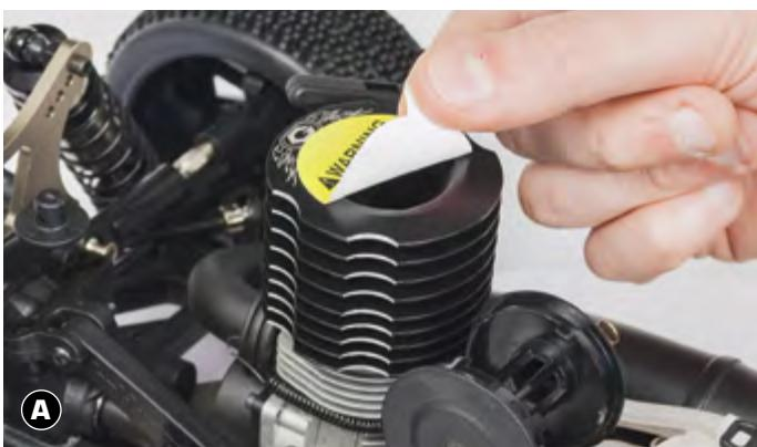
Retirer l'autocollant de protection «WARNING» se situant sur le moteur.
