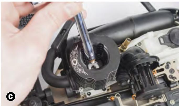
Verwenden Sie den Schlüssel, um die Glühkerzen vorsichtig in den Motorbrennraum zu schrauben
