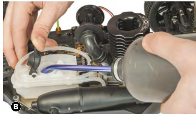
Remplir le réservoir de carburant jusqu'au bord
