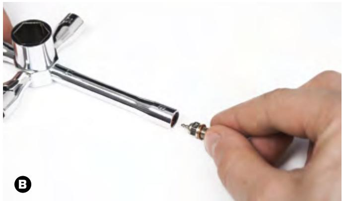
Installieren Sie die Glühkerzen am Kreuz Schraubenschlüssel
