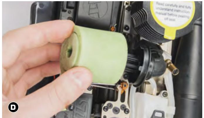
Installieren Sie den doppelte Luftfilterschaumstoff auf seine Halterung mit dem mitgelieferten Schlüssel
