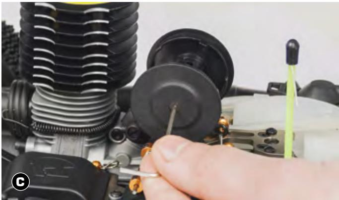
Entfernen Sie den Plastik Luftfilterdeckel
