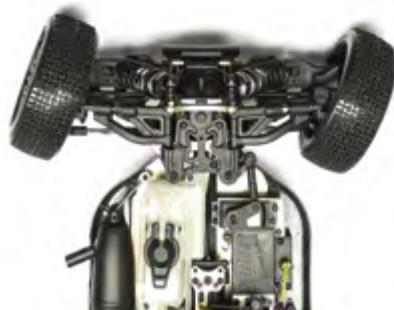
Wenn die Räder in die entgegengesetzten Richtung arbeiten, dann bedienen Sie den Servo- rückwärts-Schalter (ST in NOR Position).
