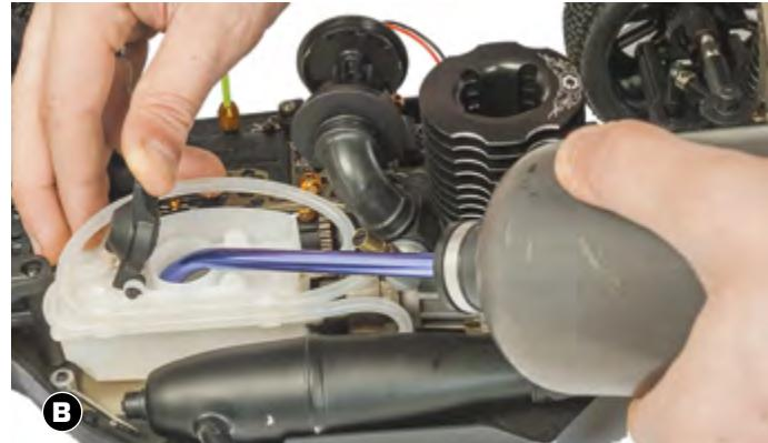
Füllen Sie den Kraftstofftank bis zum Rand
