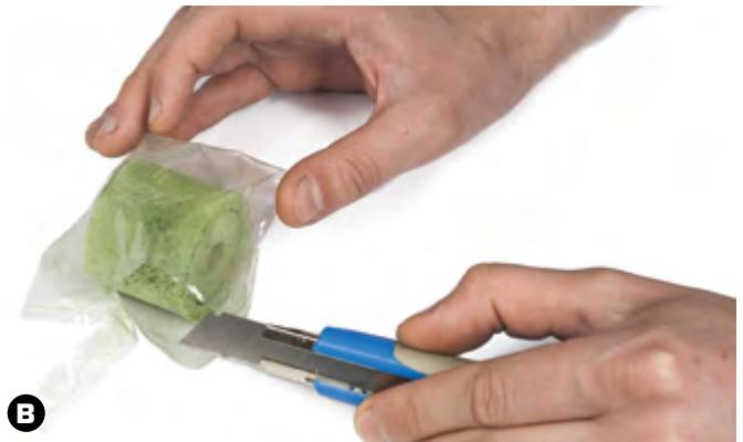
Öffnen Sie den Plastikbeutel und nehmen Sie den Schaumstoff Luftfilter heraus
