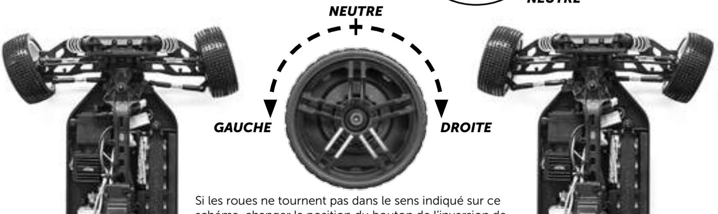
Si les roues ne tournent pas dans le sens indiqué sur ce schéma, changer la position du bouton de l'inversion de servo (ST en position NOR).
